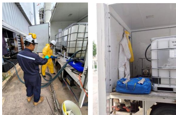
ภาพที่ 2-46 อุปกรณ์คุ้มครองความปลอดภัยส่วนบุคคลประจำรถ ขนส่งสารเคมีหรือวัตถุอันตราย
